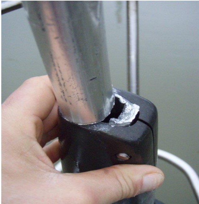
Der Materialermüdungsbruch der Rollanlage
